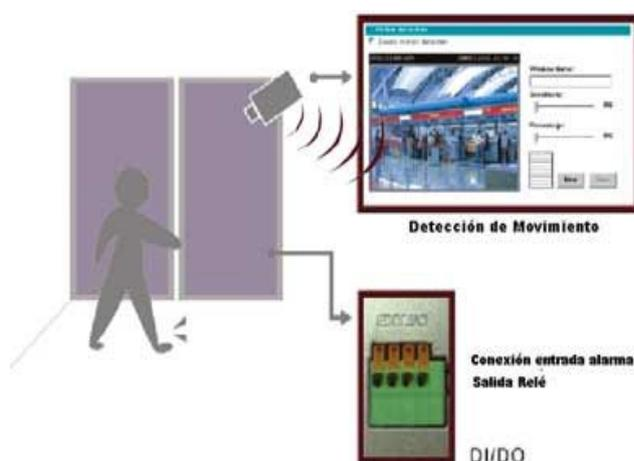
Las cámaras IP y los servidores de video suelen disponer de un sistema de detección de movimiento (utilizando el análisis instantáneo y continuado de los cambios que se
